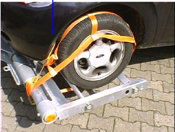
Radsicherung bei Betrieb in der Hubbrille
