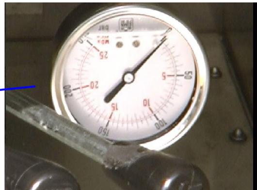
Der Betriebsdruck wird Werkseitig auf 160 Bar eingestellt. Er sollte diesen Wert weder unter noch überschreiten. Mit der Orangen Stellschraube kann der Manometer abgestellt werden.
