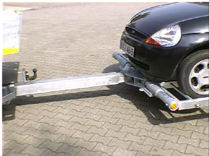
Arbeiten mit der Hydraulischen Hubbrille
