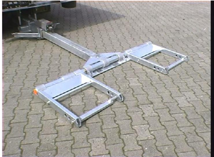
Die Verkürzungsstange (verschiedene Radgrößen) kann nach Bedarf entfernt werden.
