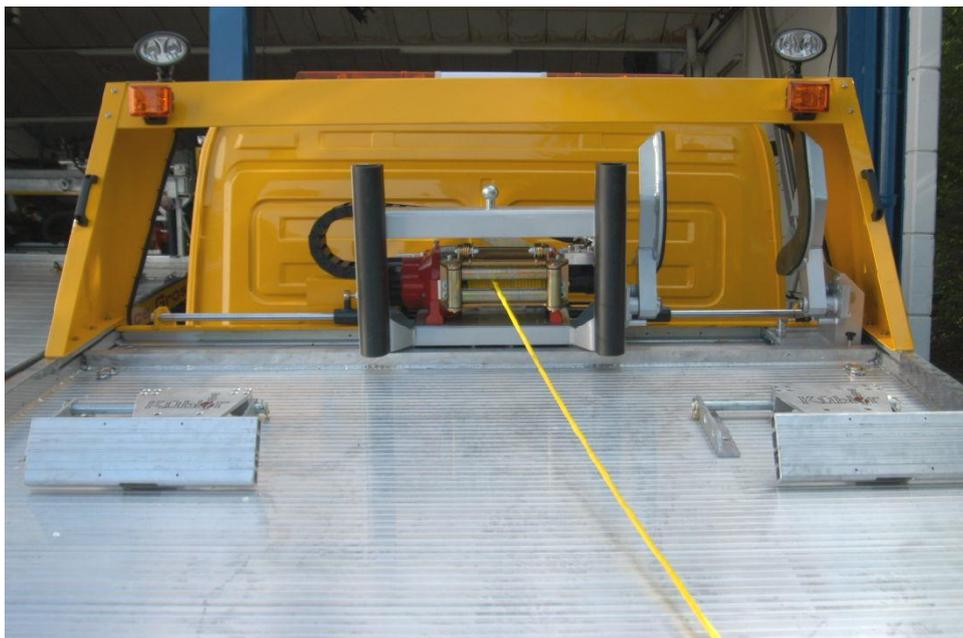
Mit dem Handsender der Funk-Fernbedienung können Sie nur die Funktionen Winde Ein/Aus betätigen
