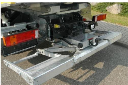
Bei Anhängerbetrieb muß die Brille etwas abgelassen werden
