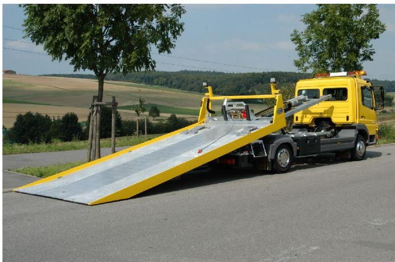
Durch betätigen des Hebels (Einfahren des Plateaus) Ladefläche einfahren.
