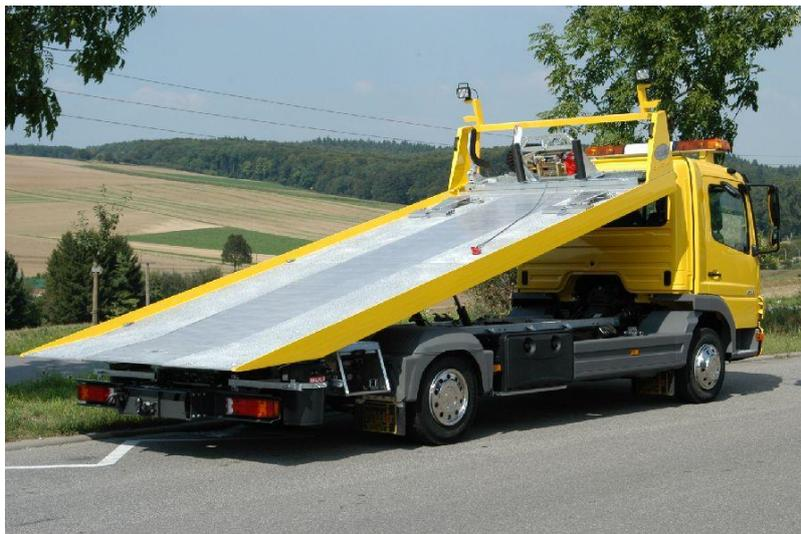
Mit dem Hebel ([Ausfahren des Plateaus](#)) die Ladefläche ausfahren.
