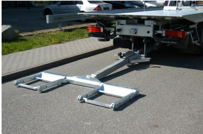
Durch betätigen des Hebels (**Heben/Senken der Hubbrille**) am Bedienungsblock Hubbrille absenken.
